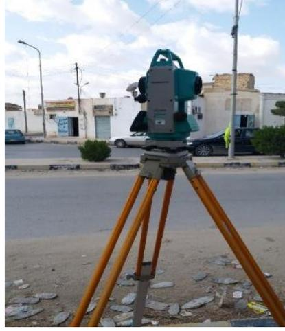
شكل (2): جهاز المحطة الكاملة Total Station.
